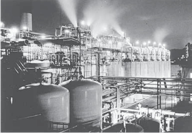
الشكل 10.14 مصنع Hakko Kyowa لإنتاج حمض أميني في اليابان تظهر 7 مخمرات كبيرة على اليمين كل واحدة بحجم 240 \text{ m}^3 ، وهي مناسبة لإنتاج L-gulamate.
